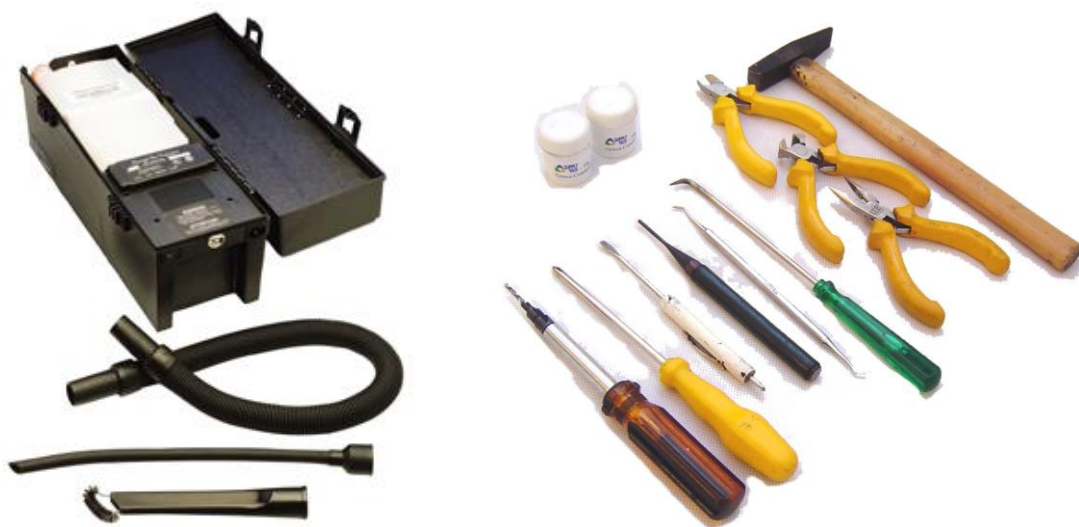
Fig (TN-580) 3 - Aspirador ESPECÍFICO de toner e algumas ferramentas que usamos no processo de condicionamento
