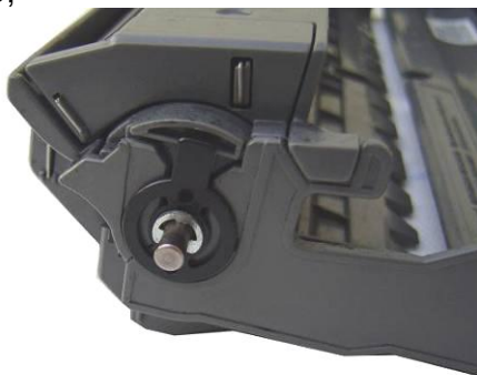
Fig (TN-580) 26 - Arruela em "C" que trava o eixo do OPC.
