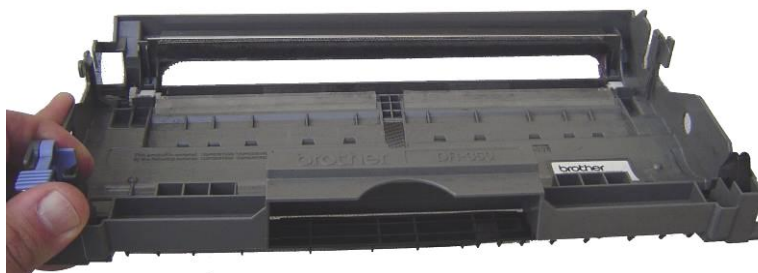
Fig (TN-580) 31 - Sistema de fotocondução. Note que esta peça é parte integrante do sistema de alimentação de folhas.
