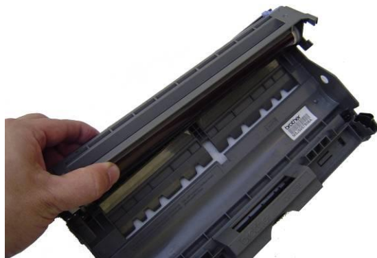
Fig (TN-580) 28 - Removendo o conjunto.
