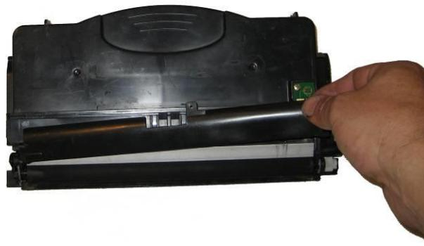
Lex E-120 4 - Removendo a lâmina dosadora.
