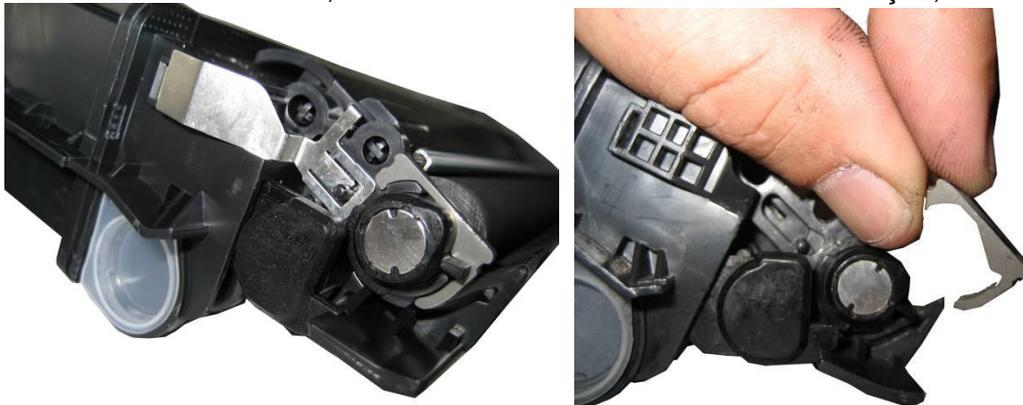
Lex E-120 5 - Lateral do contato elétrico do cartucho
