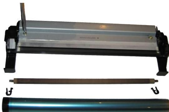
**Lex E-120 13 - Retirando a lâmina limpadora.**
