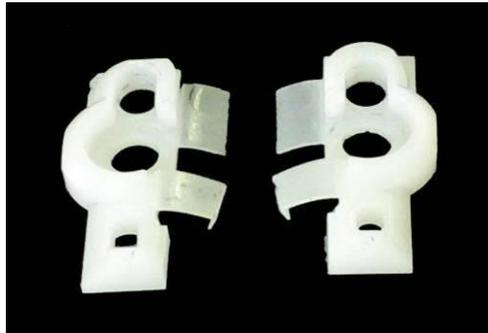
Fig (CE505) 21 - Detalhe dos limpadores de Magnético, localizados acima da dosadora.
