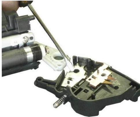
Fig (CE505) 24 - Lubrificando o contato do magnético.
