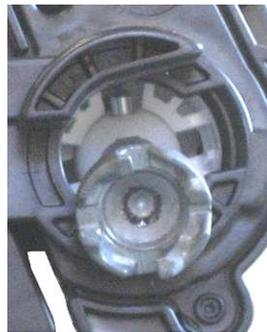
Fig (CE505) 11 - Detalhe da nova engrenagem do OPC
