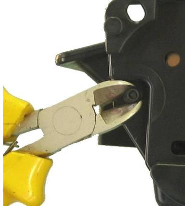
Fig (CE505) 16 - Retirando o rebite.
