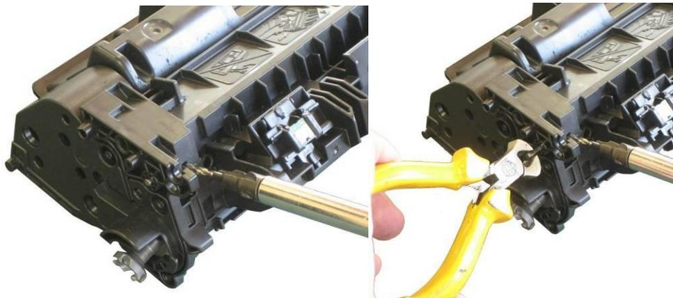
Fig (CE505) 6 - Sequência de retirada do pino do lado esquerdo.
