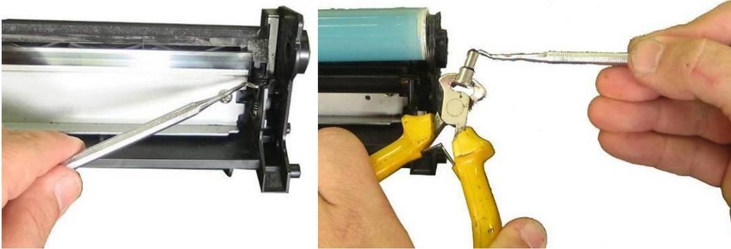
Fig (CE505) 13 - Lubrificações na seção de Lixo: Esquerda, PCR e Direita, pino de aterramento do OPC.
