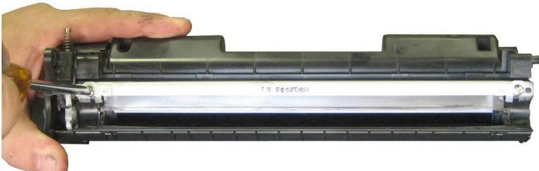
Fig (CE505) 20 - Retirando a dosadora.
