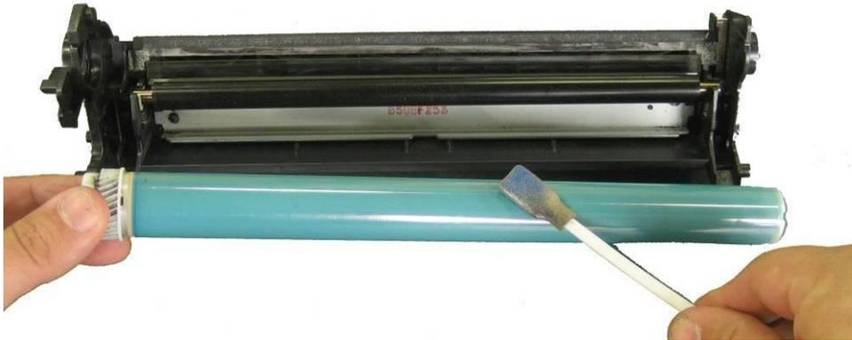
Fig (CE505) 14 - Lubrificação do OPC.
