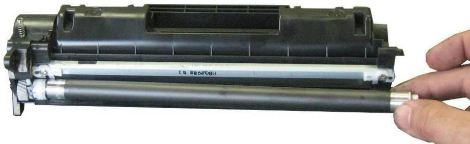
Fig (CE505) 19 - Retirando o magnético.
