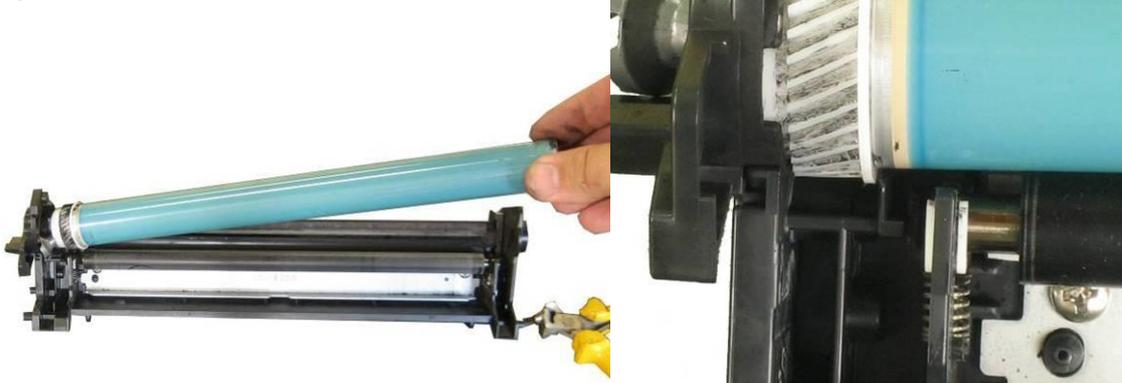
Fig (CE505) 10 - Retirando o OPC - Detalhe para o limitador de curso do OPC.
