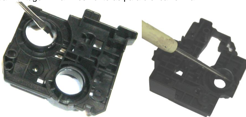
Fig. (CC530): 19 - Lubrificando os mancais do OPC com graxa de silicone.
