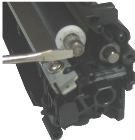
Fig. (CC530): 14 - Lubrificação do rolo de revelação com graxa condutiva.
