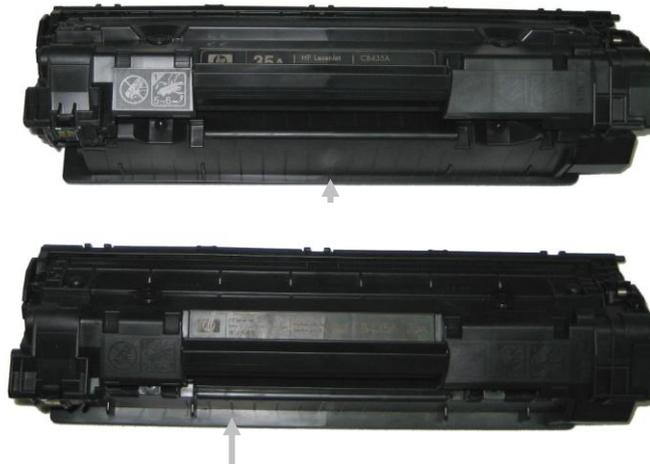
Fig. (CB435) 4 -Diferenças no reservatório de pó dos cartuchos que vêm na máquina e os vendidos na Praça: Acima um CB435 vendido e abaixo o CB435 que vêm com o equipamento.
