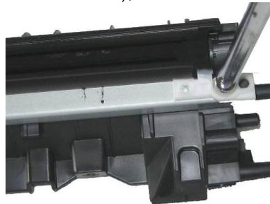
Fig. (CB435) 22 - Retirando a lâmina dosadora.
