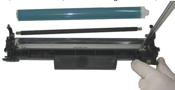
Fig. (CB435) 15 - Retirando a lâmina limpadora.
