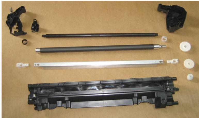
Fig. (CB435) 24 - Seção de pó totalmente desmontada.
