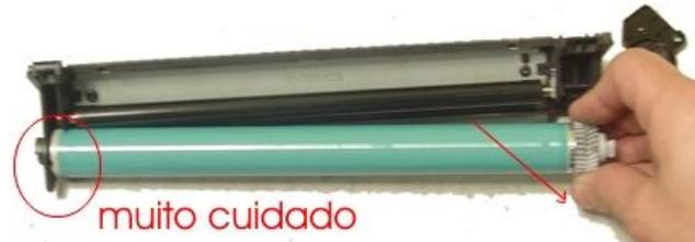
Fig. (7115) 14 - Retirando o cilindro
