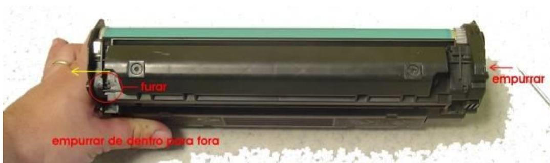
Fig. (7115) 6 - Identificação dos locais de retirada dos pinos
