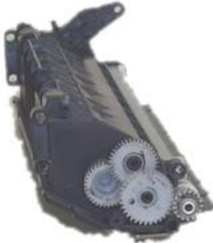
Fig. (2612) 14 - Posicionamento das engrenagens
