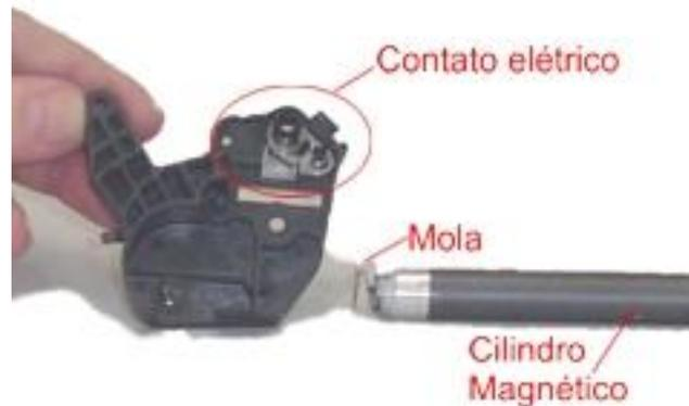
Fig. (2612) 11 Detalhe do contato do cilindro magnético
