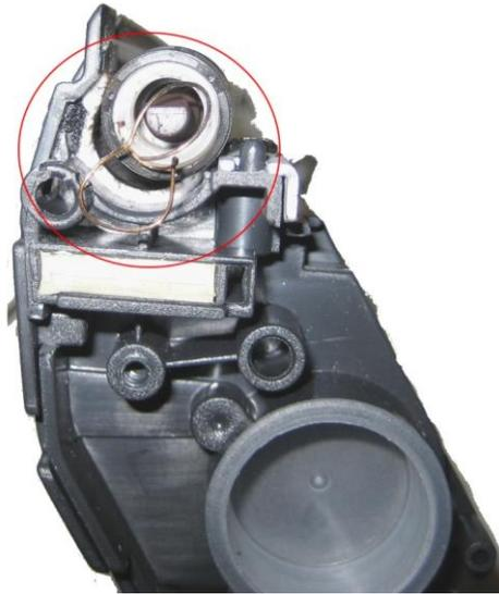
Fig. (2612) 12 - Detalhe de uma mola de contato do rolo magnético de um Q2612 danificada.
