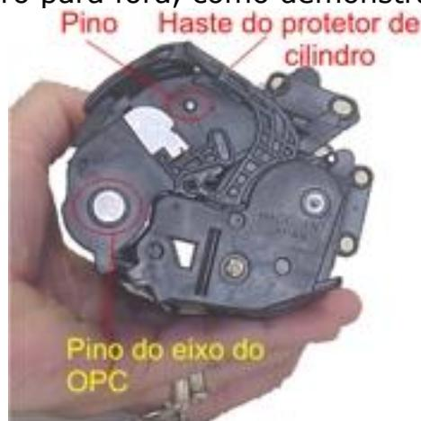
Fig. (2612) 6 - pino do eixo do OPC e que segura as duas metades.
