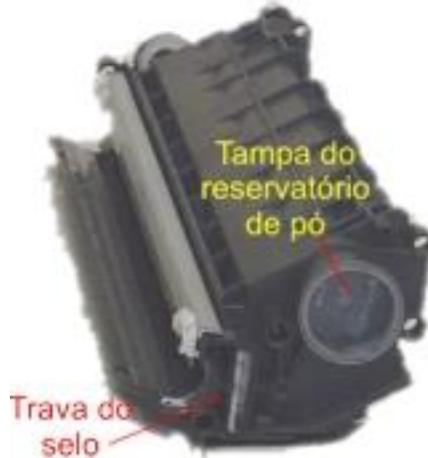
Fig. (2612) 15 - Detalhes do reservatório de pó e tampa-trava do selo de vedação
